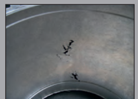
Lunker und Oberflächenfehler
