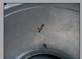
Lunker und Oberflächenfehler
