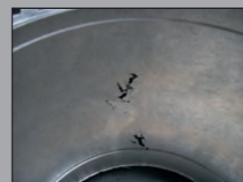
Lunker und Oberflächenfehler
