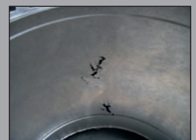
Lunker und Oberflächenfehler
