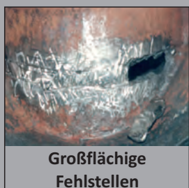
Geschlossener Lunker (nach mech. Bearbeitung)
