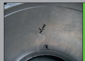
Lunker und Oberflächenfehler
