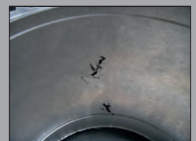
Lunker und Oberflächenfehler
